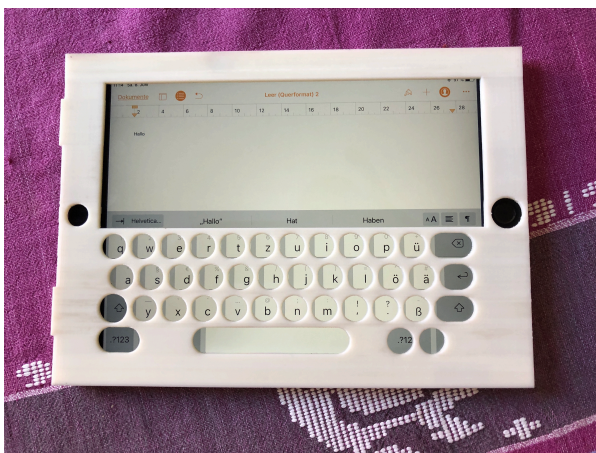
Abb. 2: Mittels 3D-Druck erstellte individuelle Fingerführung für iPad
